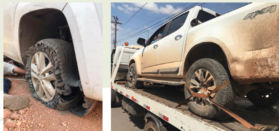
Foto 22 – Avarias causadas nos veículos 4x4 utilizados na operação devido as condições das estradas locais.
